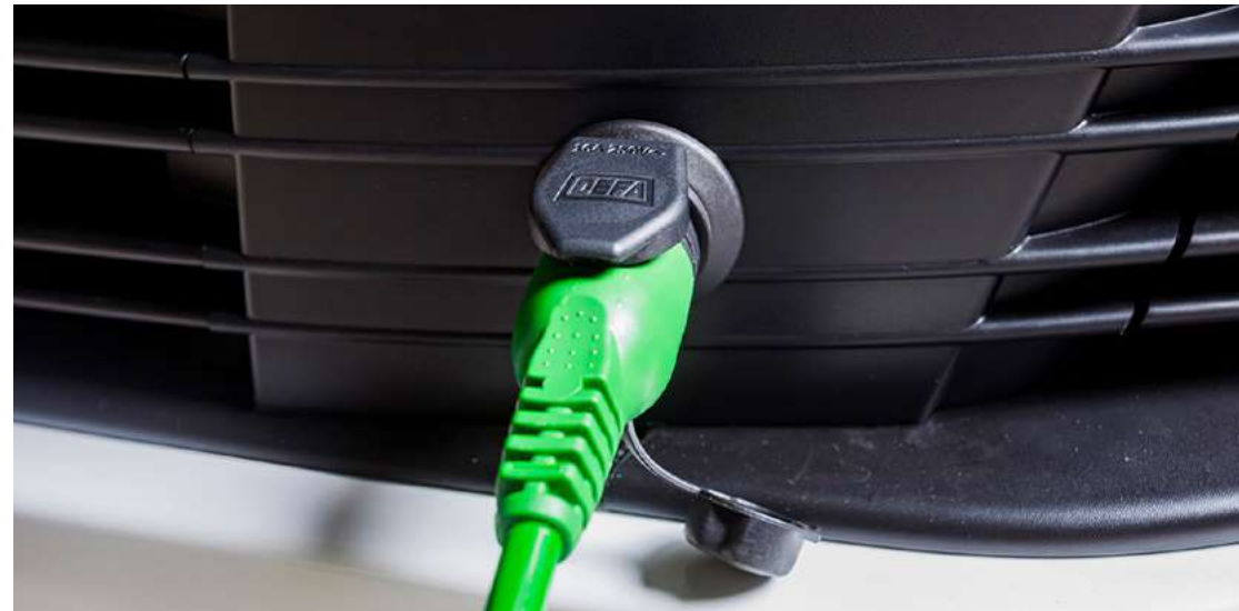
Toma de 220V Proace CAMPER
