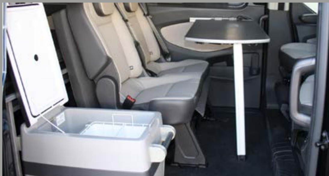
NEVERA COMPRESOR ANCLAJE FIJO
