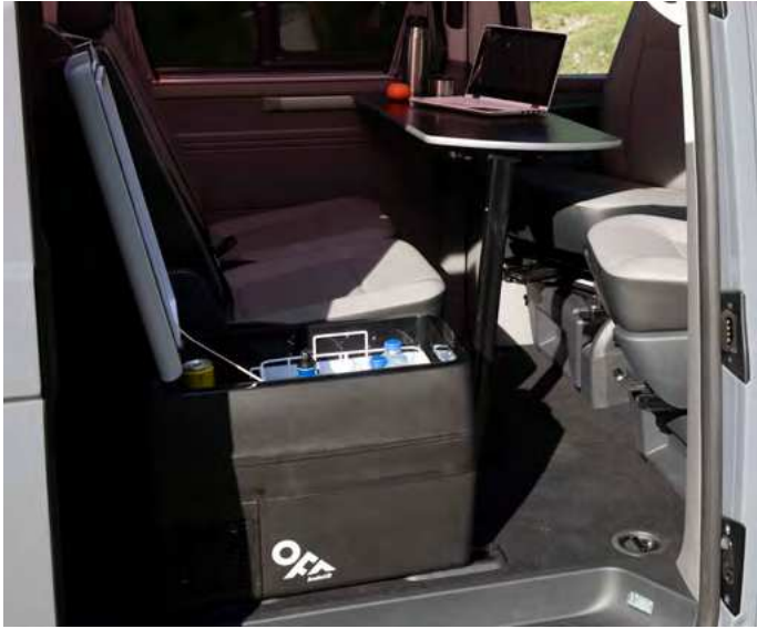
Nevera de 41 litros 12v/220 con anclaje fijo, segunda fila de asientos.
