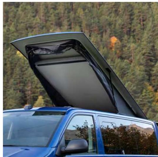
Sistema de apertura neumática, cierres rápidos con cama. Apertura Panorámica, tres ventanas y flexo led de dormitorio.
