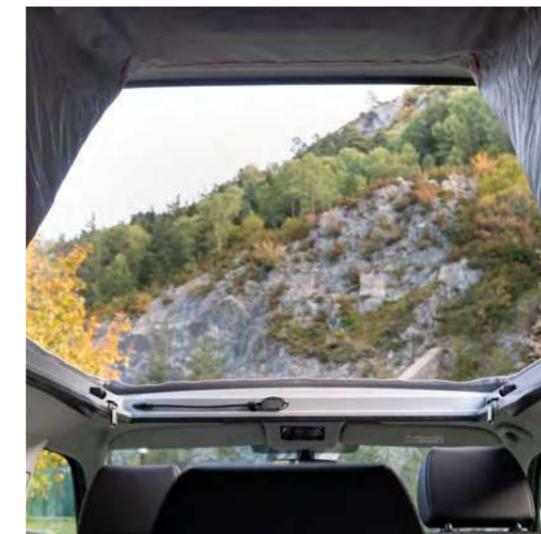
El techo, con sistema de inyección VEX, está dotado de un sistema de apertura neumática, cierres rápidos con pernos integrados de seguridad, con una cama con somier y discos flexibles ergonómicos, tres ventanas con mosquitera y flexo led de dormitorio.
